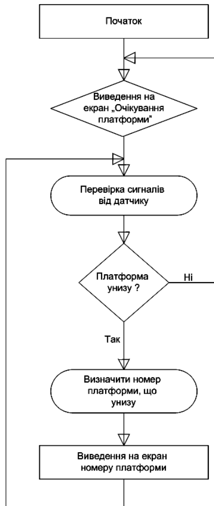
Рисунок 3.9 – Алгоритм роботи датчика позиціонування
