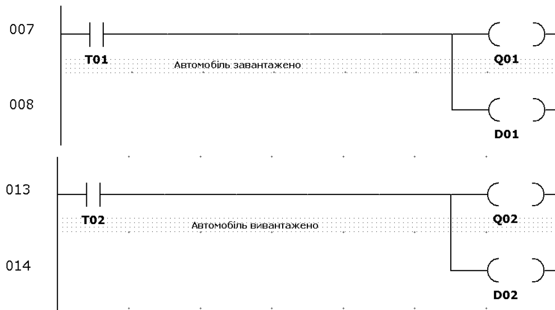
Рисунок 3.18 – Комутація виходів ПЛК
