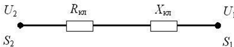
Рис. 2.6. Схема заміщення кабельної лінії (шинопроводу)
