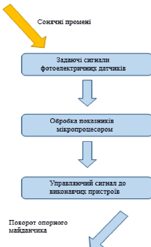
Рисунок 2.1 – Принцип роботи системи стеження з фотоелектричних давачами.
