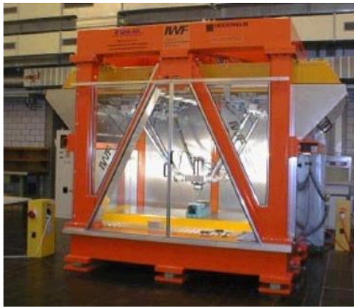
Рис. 1.10. Верстат мод. HEXAGLIDE фірми ETH (Німеччина): а – зовнішній вигляд; б – схема верстата
