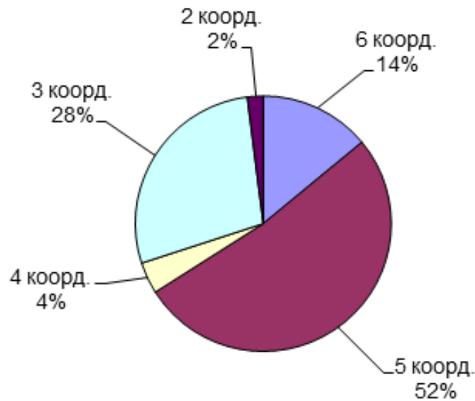
Рис. 1.1. Розподіл технологічного обладнання з паралельною кінематикою за кількістю ступенів вільності
