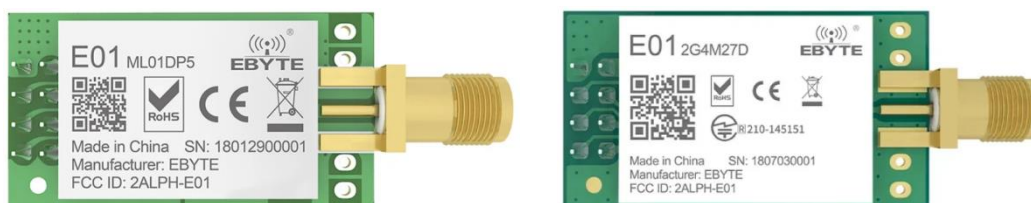
Рисунок 2 – Трансивери E01-ML01DP5 та E01-2G4M27D
