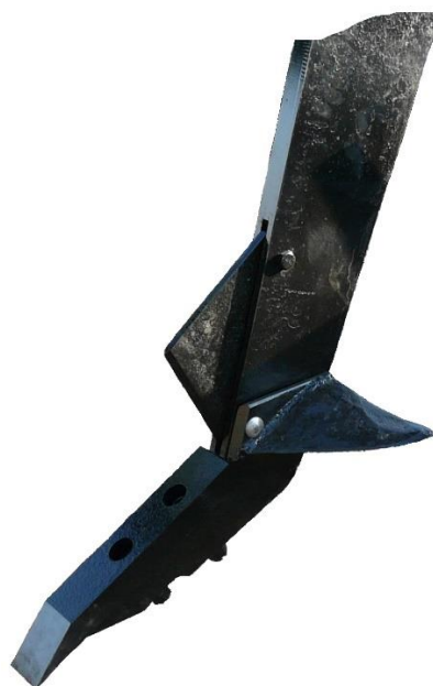
Рис. 6. Зображення вдосконаленої лапи із крилами біонічної форми типу дельфінячий хвіст
