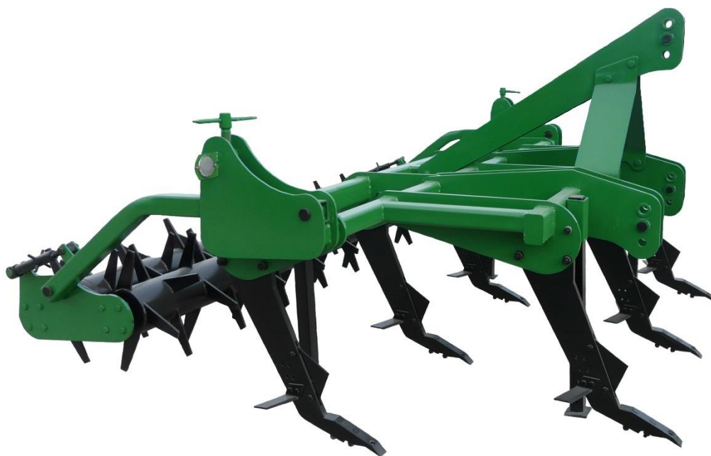
Рис. 5. Комбінований ґрунтообробний агрегат для основного безполіцевого обробітку ґрунту ЧН-3,5
