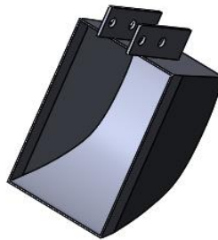
Рис. 2.3 Ковш - виконання реалістичної 3D-моделі у середовищі SolidWorks
