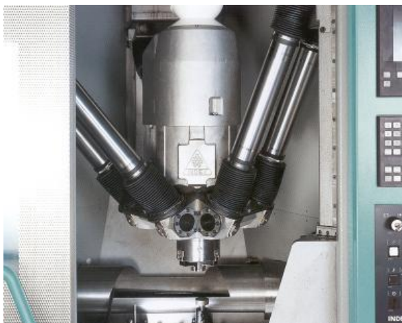
Рис. 1.7. Верстат з паралельною кінематикою мод. INDEX V 100
