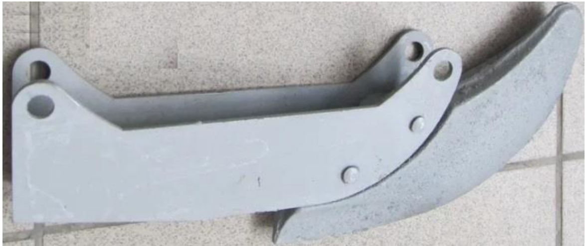
Рисунок 2.3 – Серійний сошник сівалки УПС 12
