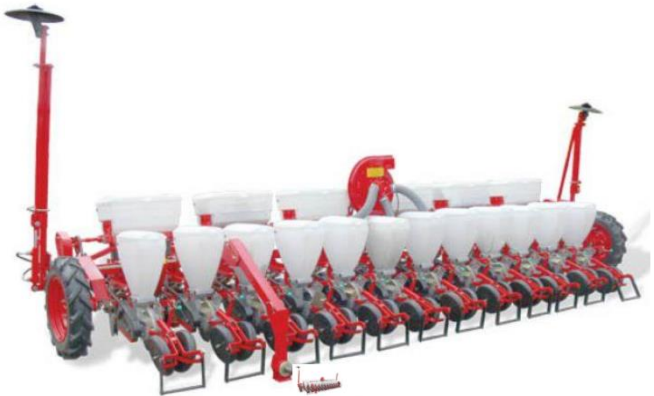
Рисунок 2.1 – Пневматична сівалка точного висіву УПС-12
