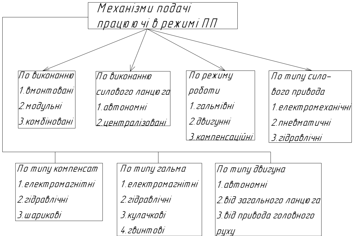
Рисунок 2 – Класифікація механізмів подачі, які працюють як накопичувачі потужності
