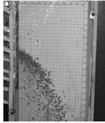
Рисунок 2 – Схема вимірювання координат (а) та загальний вигляд установки для визначення швидкості введення зерна (б)
