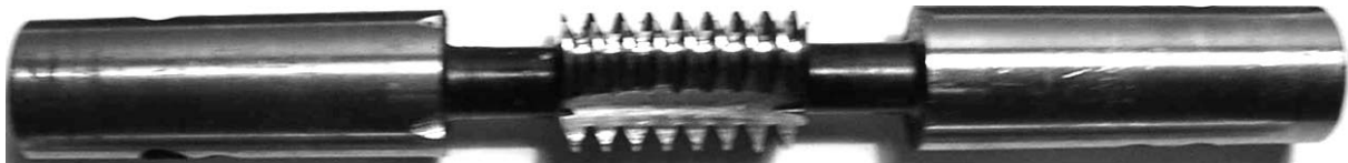
Рисунок 1 – Хвостова одновиткова спеціальна черв'ячна фреза [2]
