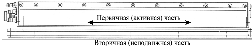
Рисунок 1 – Схема линейного двигателя для перемещения шлифовальной бабки станка
