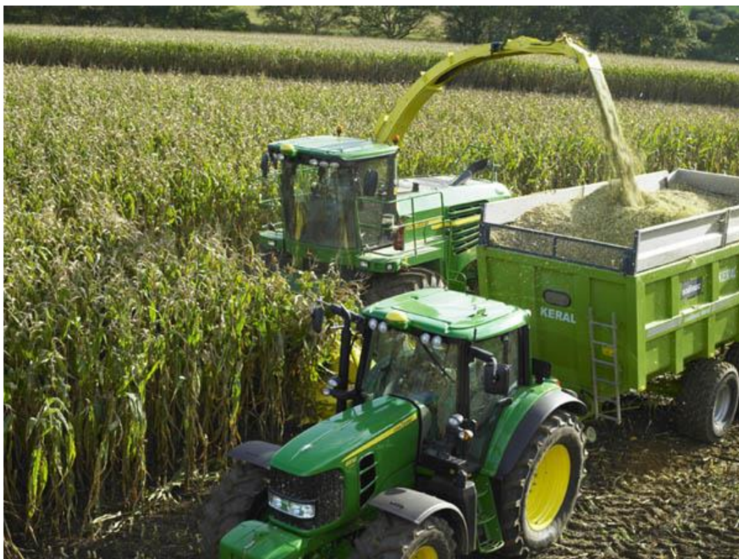
Рис. 3.3. Процес збирання кукурудзи на силос комбайном John Deere 7350
