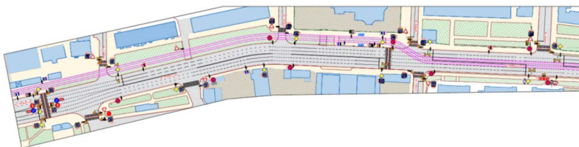
Рисунок 9 – Варіант перенесення трамвайних колій з проїзної частина на окреме трамвайне полотно на перехресті вул. Полтавський Шлях – вул. Кандаурова
