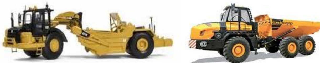
Рисунок 1.3 Агрегування робочого обладнання з одновісним тягачем
