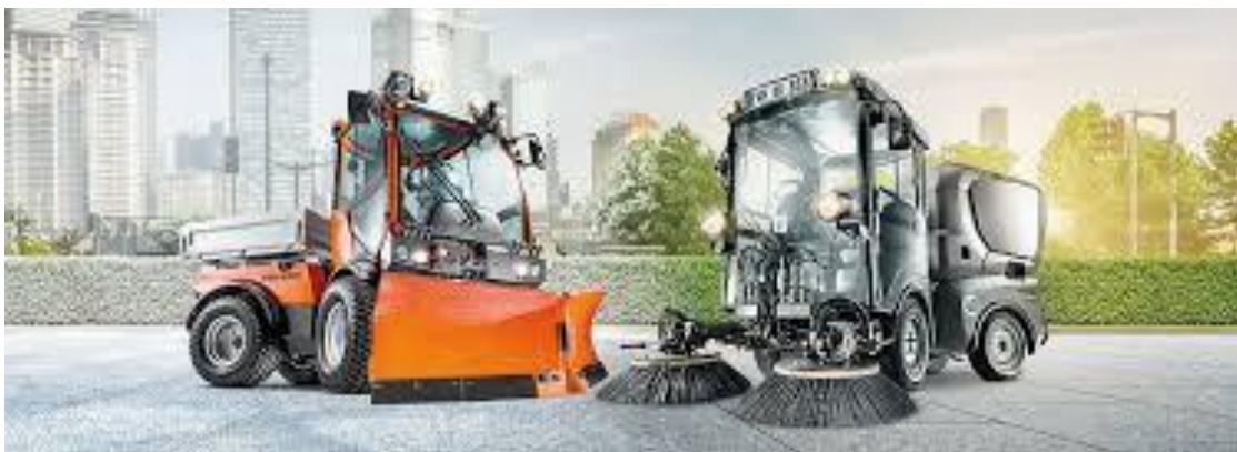
Рисунок 1.4 Агрегатування робочого обладнання з двохвісним тягачем
