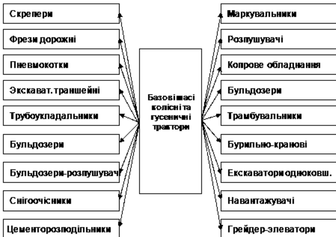
Рисунок 1.5 Будівельне обладнання, яке агрегатується з тракторами
