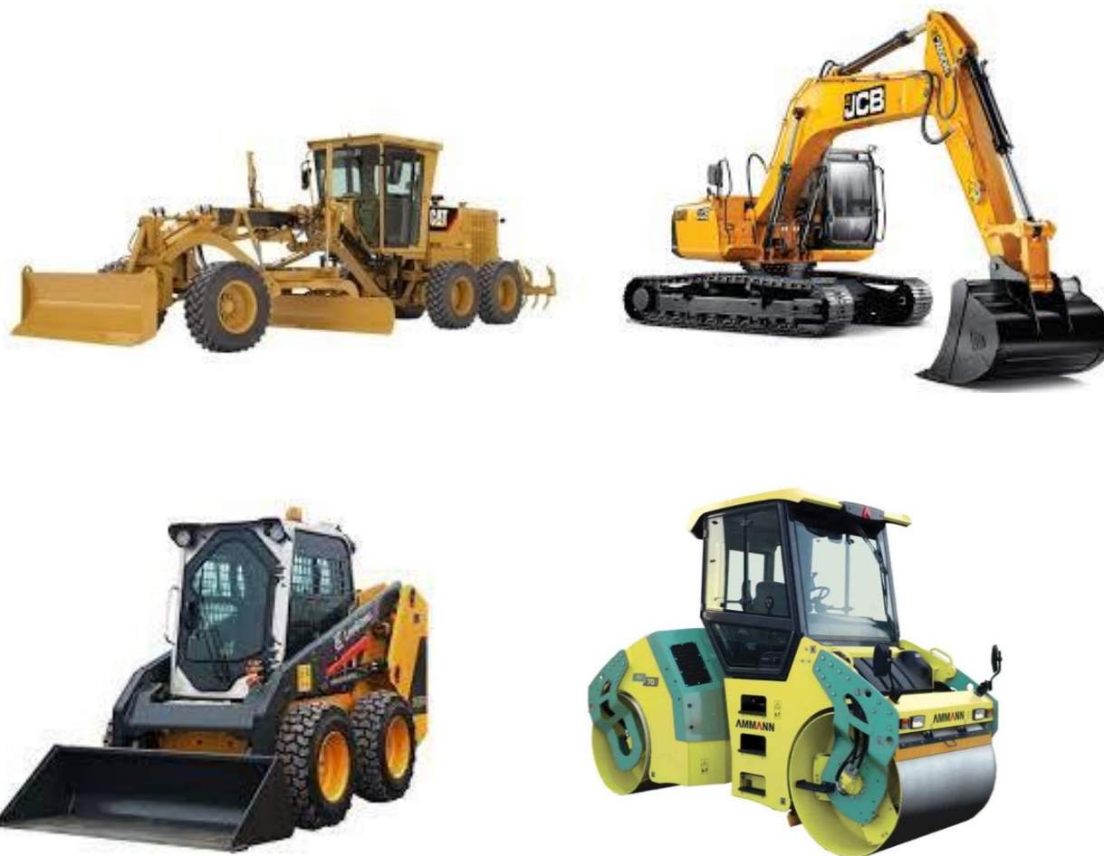
Рисунок 1.2 Будівельні і дорожні машини, які базуються на спеціальних тягачах
