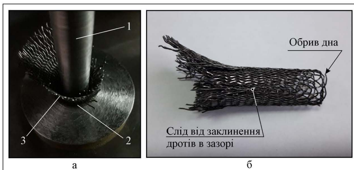
Рис. 3.5. П'яте витягування циліндричної деталі із металевої сітки: а – момент заклинення дротів в зазорі; б – деталь після витягування; 1 – пуансон; 2 – матриця; 3 – заготовка в процесі витягування
