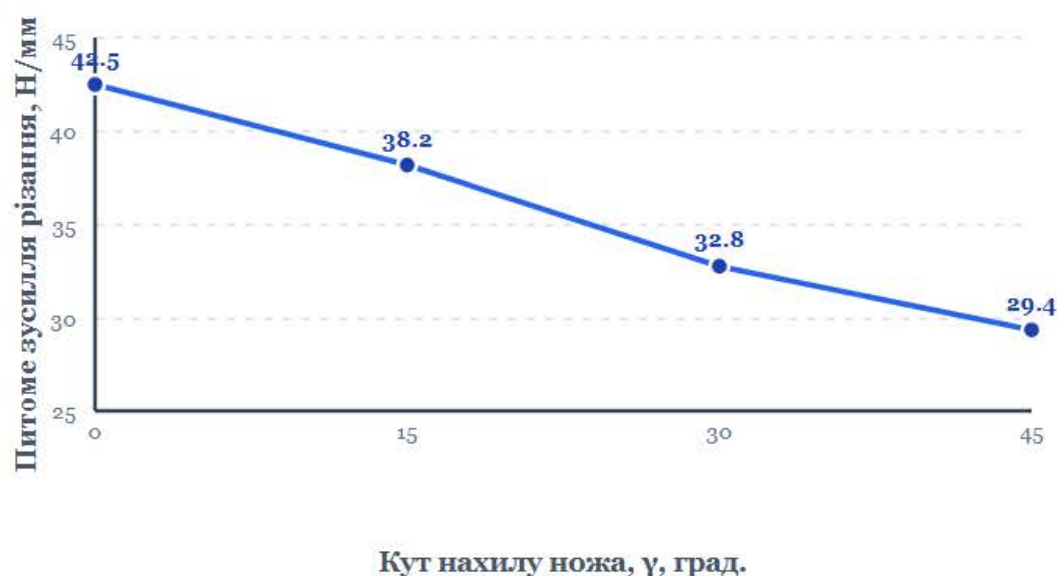
Рисунок 3.4 – Залежність питомого зусилля різання від кута нахилу ножа
