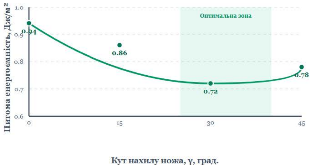
Рисунок 3.5 – Залежність питомої енергоємності процесу від кута нахилу ножа
