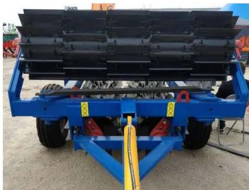
Рис. 2.3. Загальний вигляд мульчувача вітчизняного виробництва КПВ-6 з шаховим розташуванням ножів
