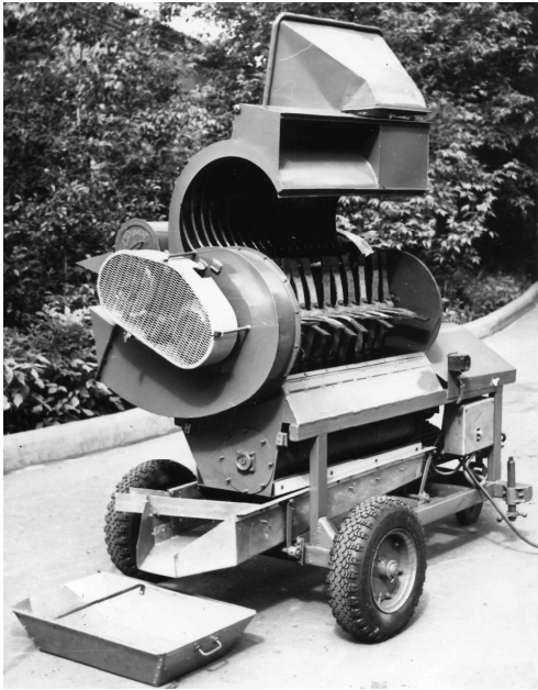
Рисунок 1- Молотилка МСУ-1, оборудованная барабаном с эластичными бичами
