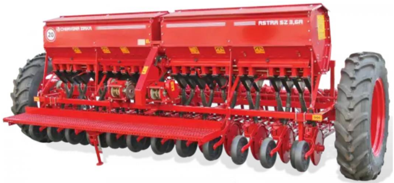
Рисунок 3.1 – Сівалка зернотукова СЗ-3,6
