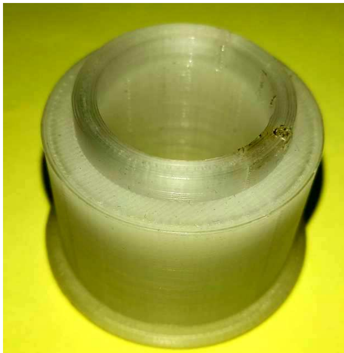
Рисунок 1.8 – Втулка, виготовлена методом 3D друку із пластика PETG
