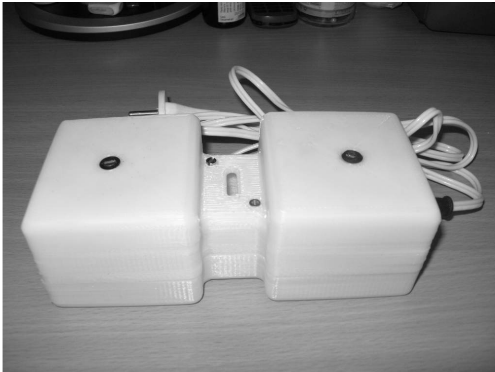
Рисунок 1.2 – Надрукований на 3D принтері корпус медичного прибору для магнітної терапії
