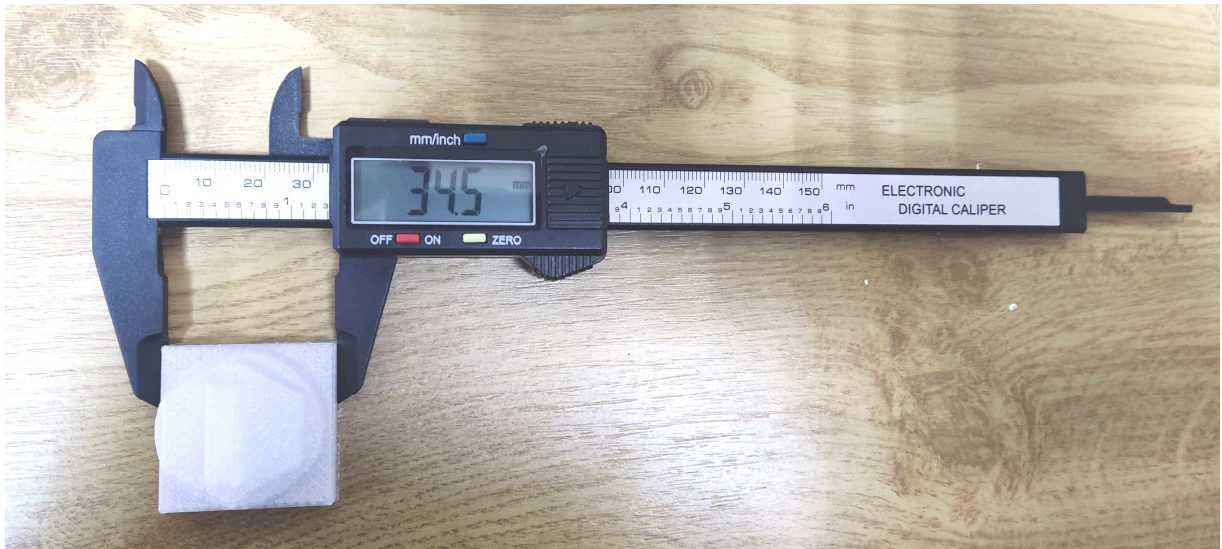
Рис. 2.9 – Вимірювання надрукованого зразка за допомогою штангенциркуля
