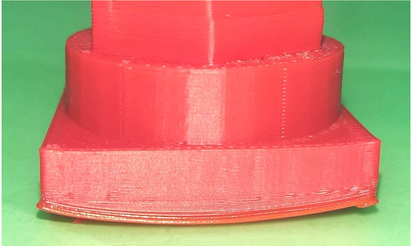
Рисунок 3.3 – Деформація основи по кутам зразка з ABS пластика
