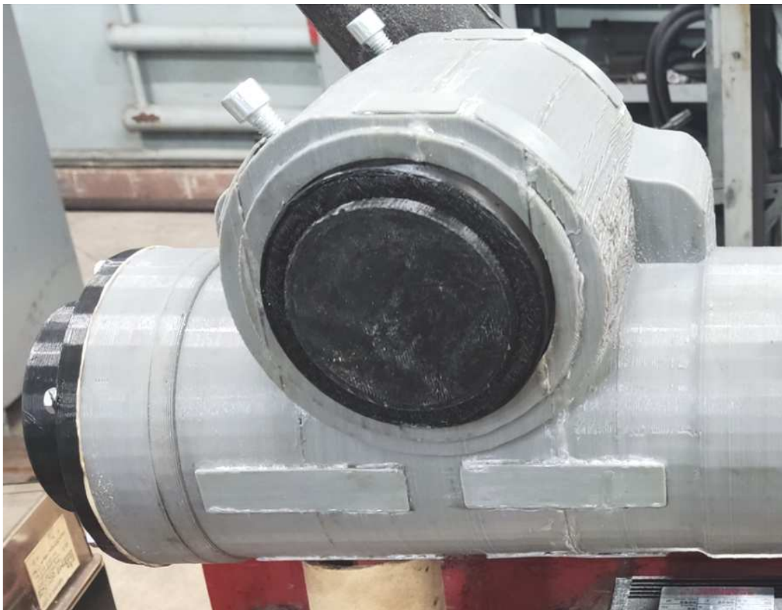
Рисунок 3.8 – Корпус прототипу електропідсилювача, надрукований із декількох частин, які потім були з'єднані поміж собою за допомогою високоміцного клею
