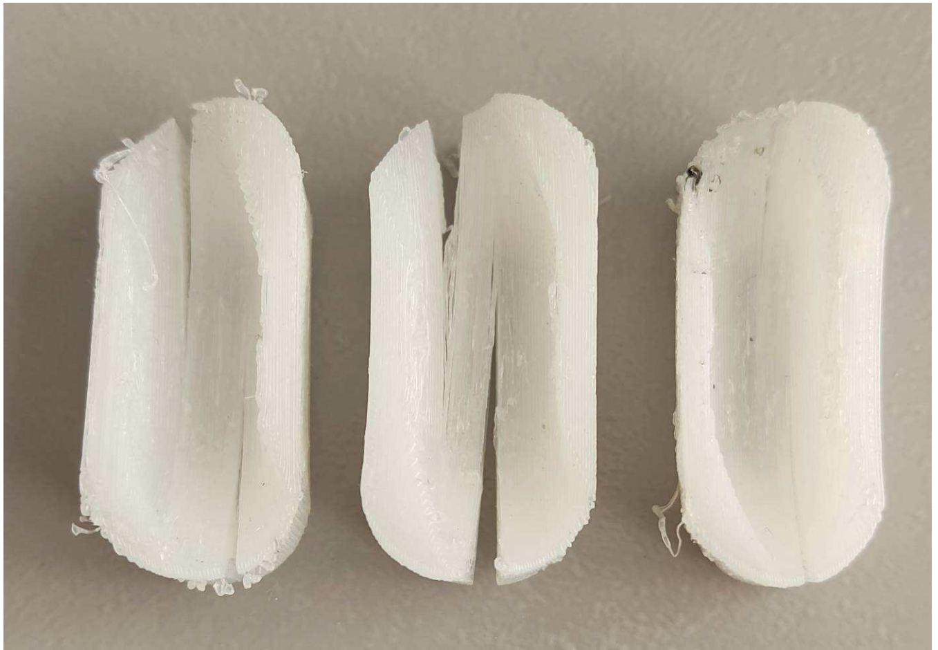
Рисунок 1.7 – Нейлоновий вкладиш для кулько-гвинтової передачі, який розтріскався внаслідок використання філаменту з підвищеною вологістю
