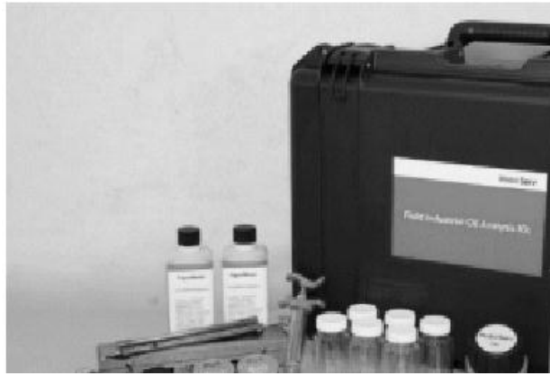
Рис. 2.10. Комплект для аналізу промислових мастил Mobil Serv Field
