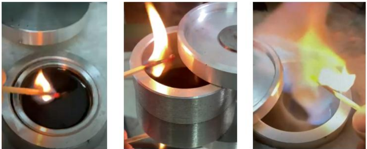
Рис. 3.6. Результати дослідження експрес-методу визначення наявності палива в моторному мастилі: а – Shell Rimula 10W40 (125 год.); б – Лукойл 10W40 (150 год.); в – Shell Helix ultra extra 5W30
