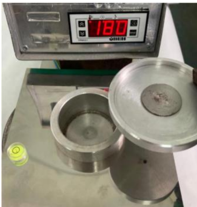
Рис. 3.3. Електротигель для реалізації експрес-тесту визначення наявності та кількості пального в моторному мастилі
