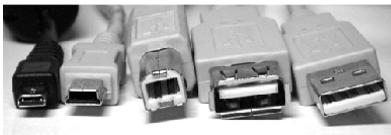
Рисунок 1.2 – Зліва на право: micro USB, mini USB, B-типе, A-типе роз'єм, A-типе конвектор
