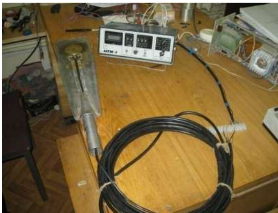
Рисунок 2.18 - Динамометричний зонд, підключений до блоку живлення та ЦТІ (Цифровий тензометричний Вимірювач).
