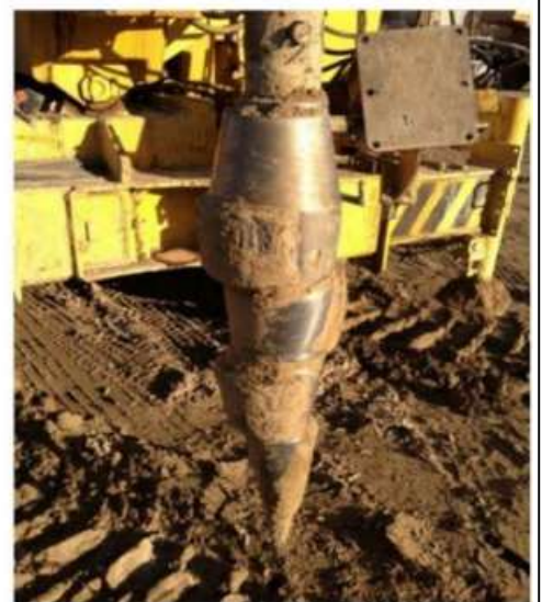
Рисунок 2.4- Розкочувач свердловин а) - зразок 1967р.; б) - зразок 2008р.
