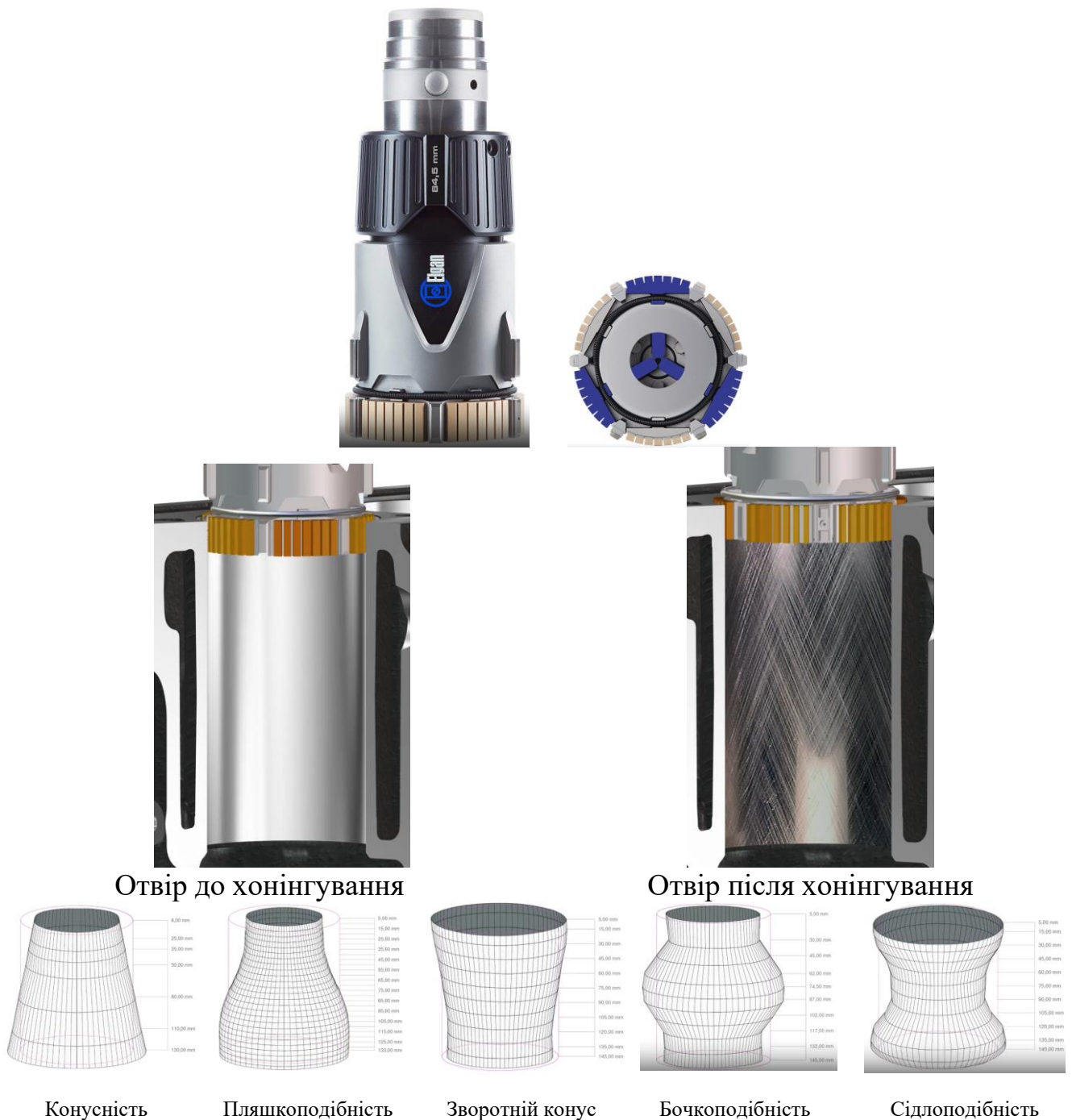
Рис. 2.29 Хонінгувальна голівка для обробки отворів відповідальних деталей та види відхилень форми які її застосування дозволяє виправити
