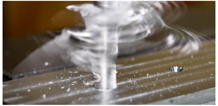
Рис. 2.2 Залипання стружки при обробці глибоких отворів в деталях із алюмінієвих сплавів
