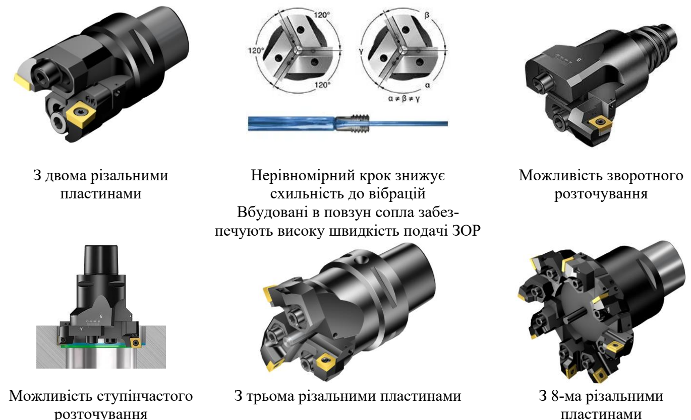
Рис. 2.15 Особливості та типи чорнових розточувальних голівок
