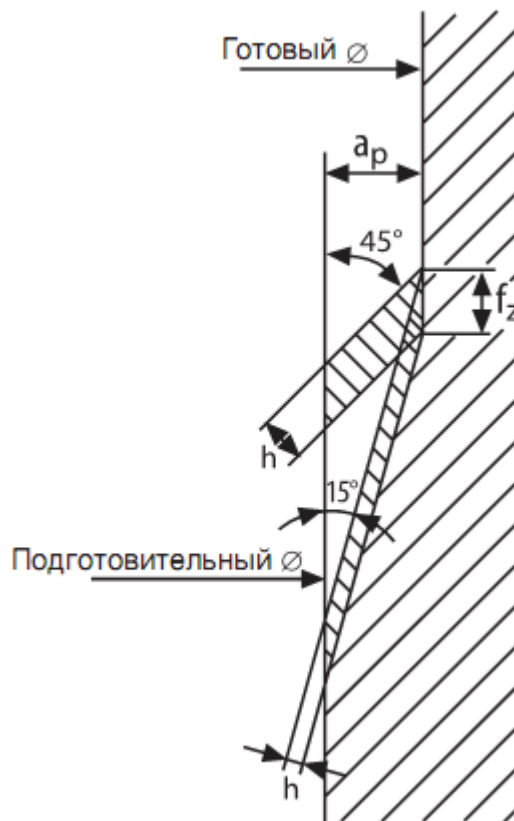
Рис. 2.11 Залежність товщини зрізаного шару h від кута в плані k
