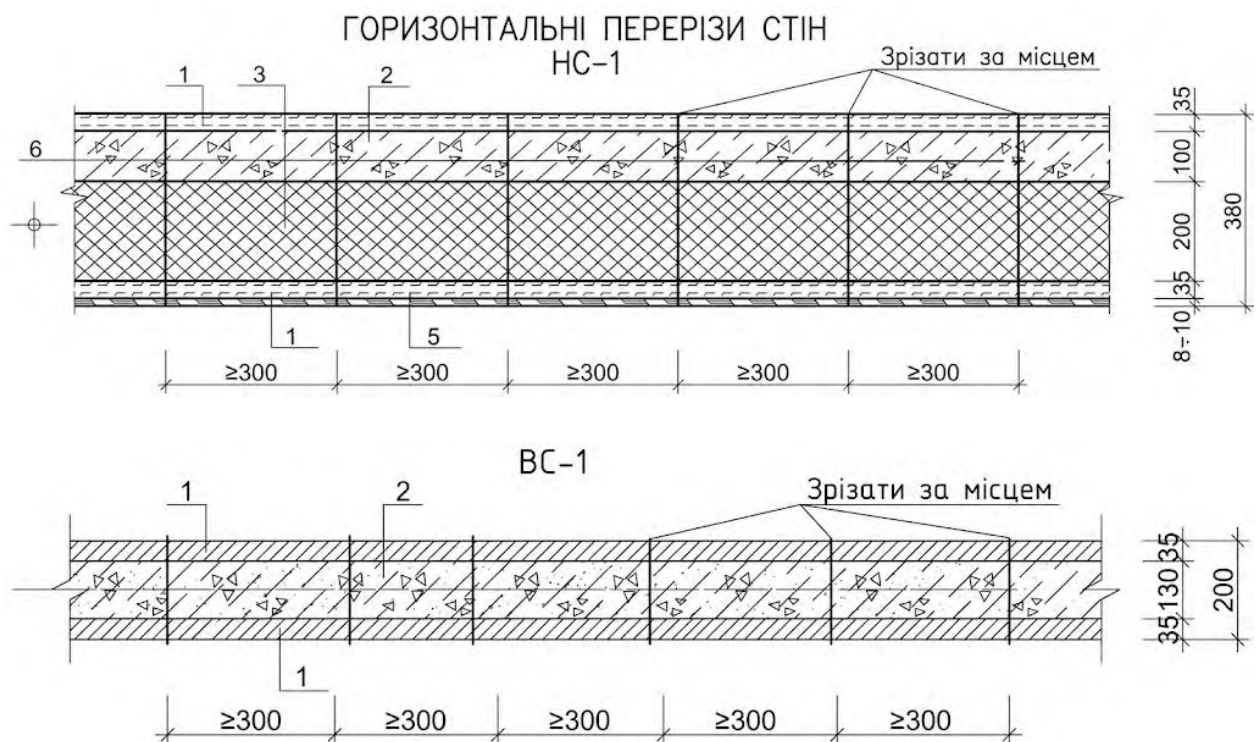
Рис. 2.1. Схема влаштування стін у системі з незнімною опалубкою з ЦСП.
