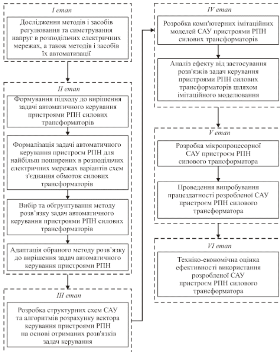
Рис. 1.14. Схема розв'язання задачі автоматичного керування пристроєм РПН трансформатора
