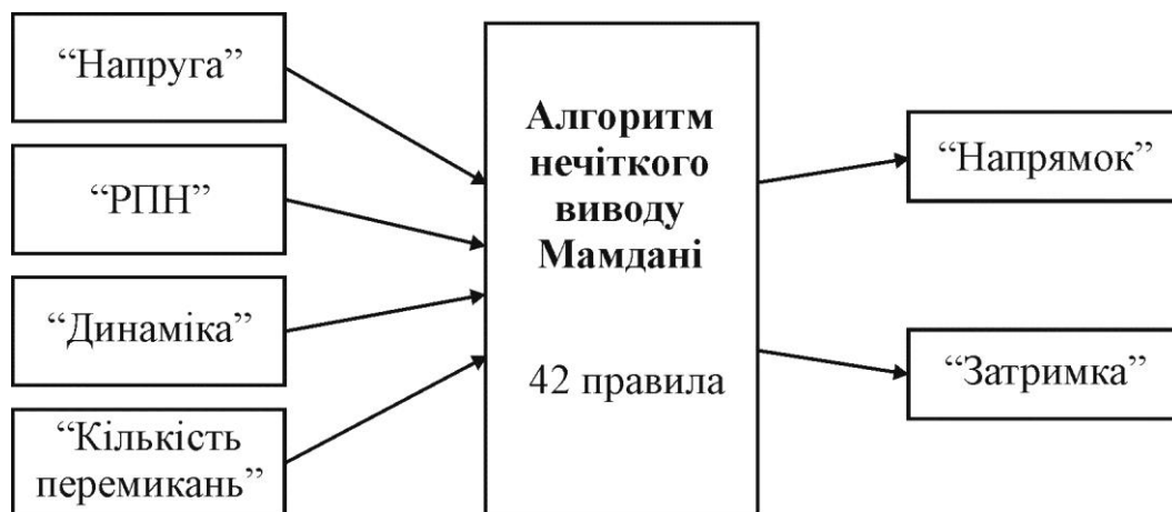
Рис. 1.9. Блок-схема регулятора пристроєм РПН на основі нечіткої логіки
