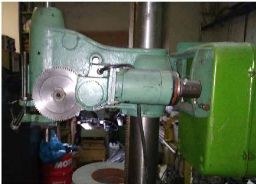
Рис. 4.3. Приклад встановлення мотор-редуктора на установку для РОД
