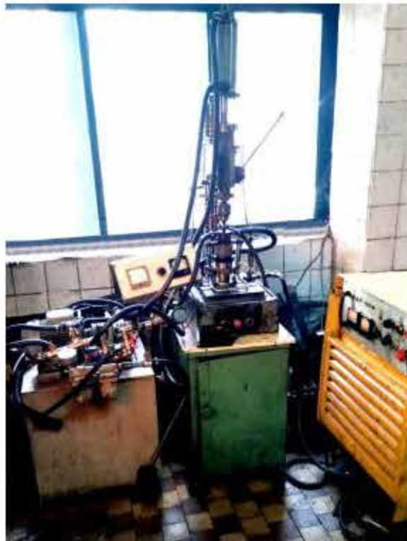
Рис.2.2. Установа РОД з використанням ЕЕГ встановленої на настільному свердильному верстаті
