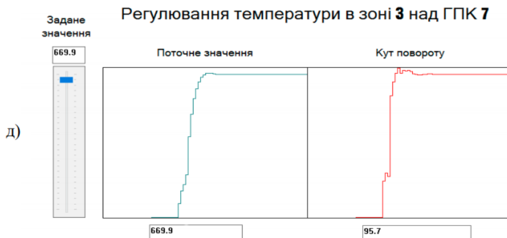
Рисунок 3.4 – Графік регулювання тиску (рис 3.4 а, рис 3.4 б, рис 3.4 в), та температури (рис 3.4 г, рис 3.4 д)
