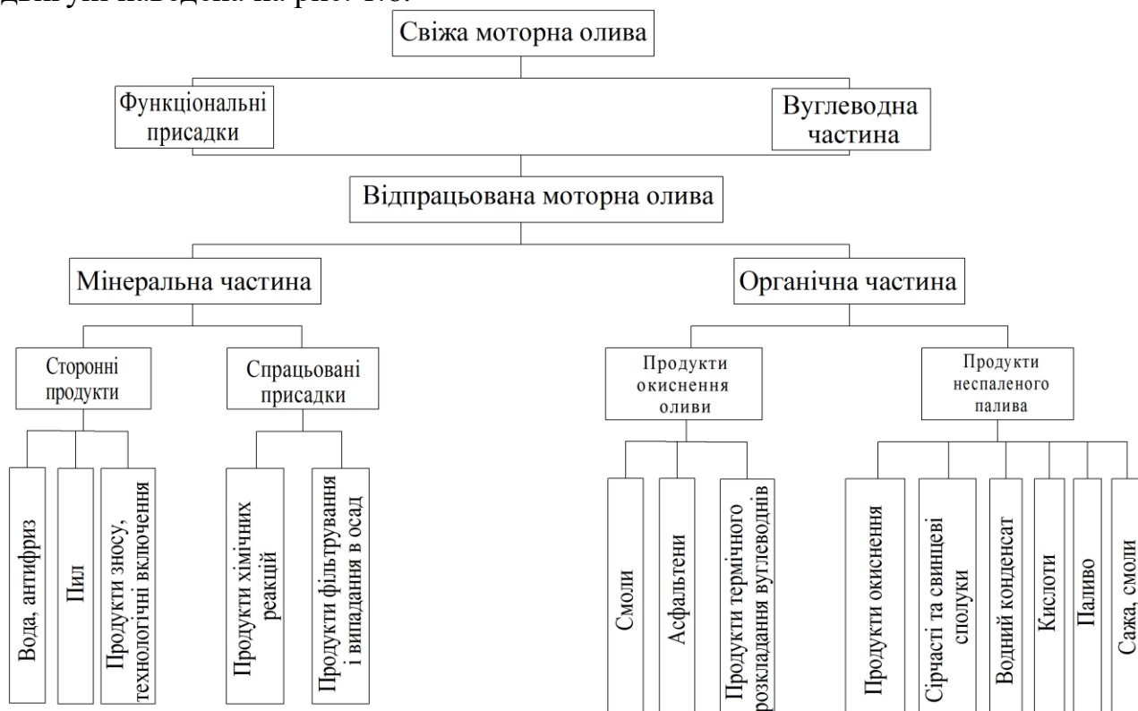
Рисунок 1.6 – Схема зміни складу моторної оливи з напрацюванням
