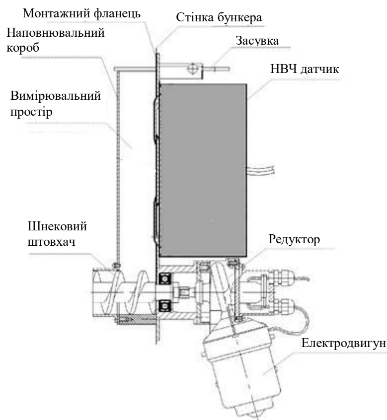
Рисунок 2.4 – Потоковий мікрохвильовий вологомір MICRORADAR – 113C2P
