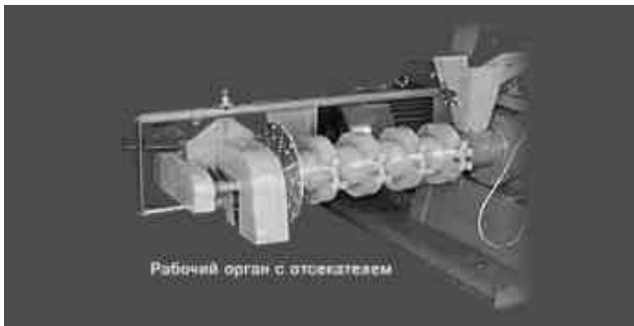
Рисунок 1.2 – Робочий орган з відсікачем
