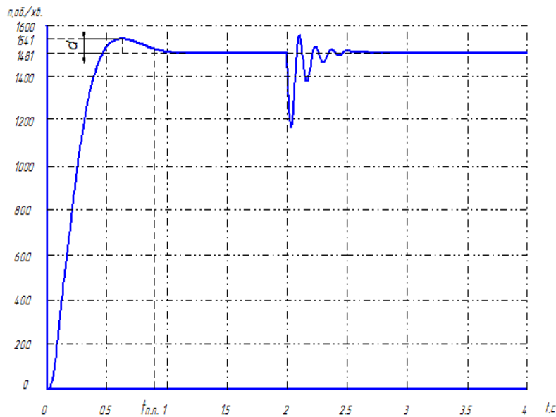
Рисунок 4.11 – Графік перехідного процесу асинхронного двигуна з від’ємним зворотнім зв’язком за швидкістю з ПД-регулятором
