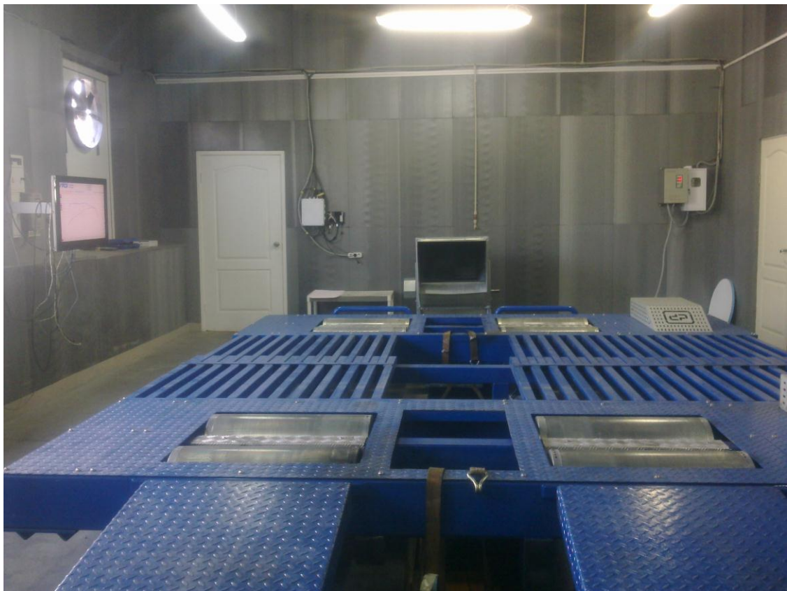
Рисунок 3.1 - Діагностичний стенд Dyno Project 4WD СТО «Best Car Service» (м. Кропивницький)
