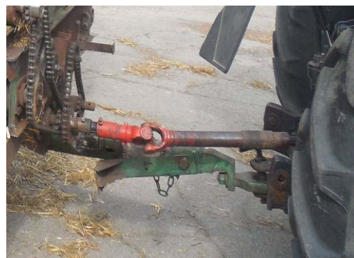
Рисунок 1 – Загальний вигляд розкидача підстилки та зчеплення його з трактором класу 0,9
