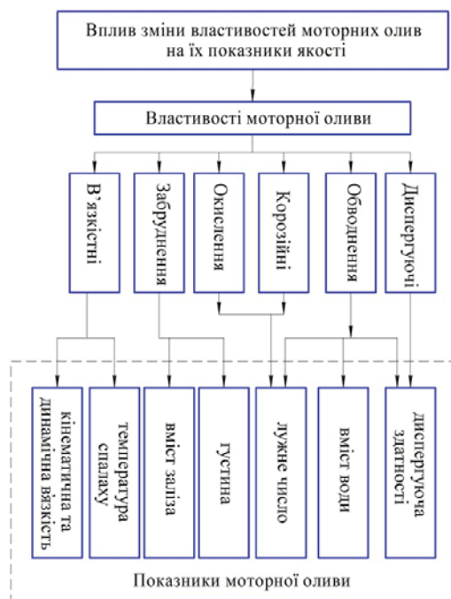
Рисунок 1 – Схема впливу напрацювання двигуна на зміну показників якості моторної оливи Джерело: розроблено автором
