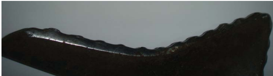
Рисунок 2 – Загальний вид зносу експериментально лапи (вид знизу)
