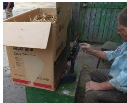
Рисунок 3 – Вимірювання об'єму та щільності підстилкового матеріалу
