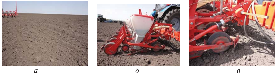
а – незадовільна якість обробітку ґрунту за показником гребенистості та грудчоватості; б та в – робота висівних секцій сівалки в незадовільних умовах
