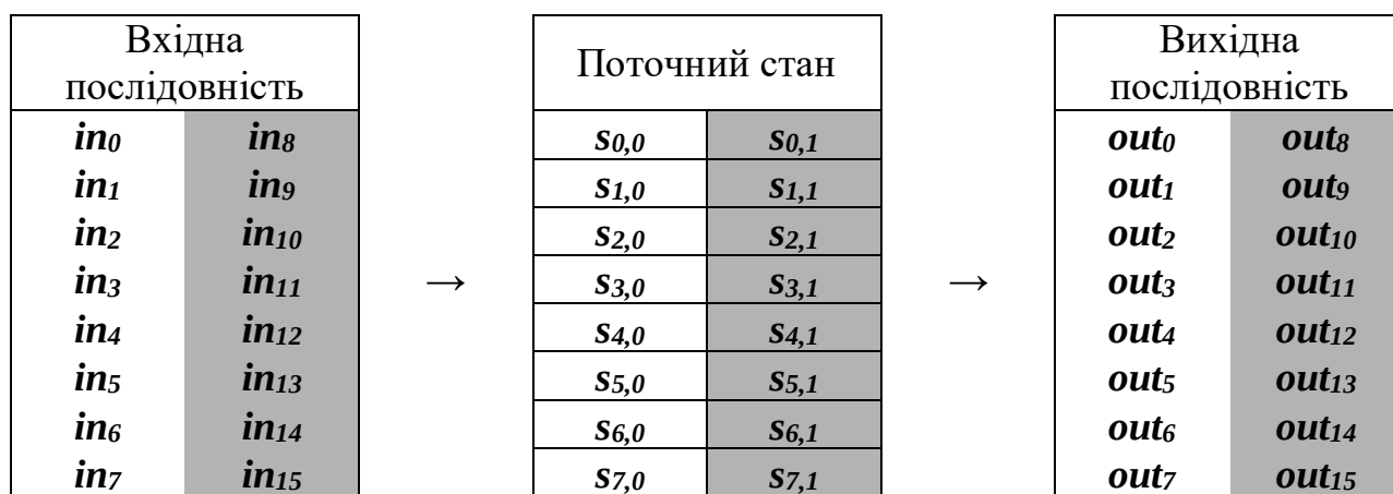
Рисунок 17.12 – Заповнення початкового стану для довжини блоку 128 біт
