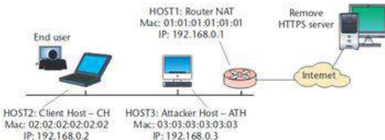
Рисунок 19.3 – Стандартна конфігурація мережі. Користувач на хості клієнта (CH) хоче здійснити безпечну транзакцію, але вразливий для атаки "людина в середині".
