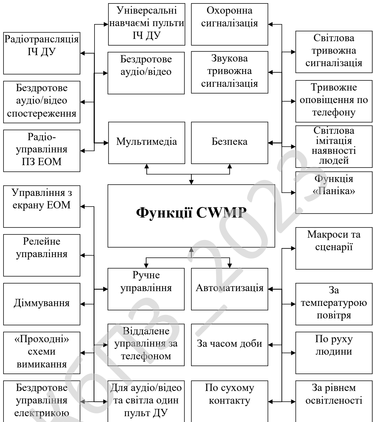
Рисунок 3.2 – Функціональна схема системи
