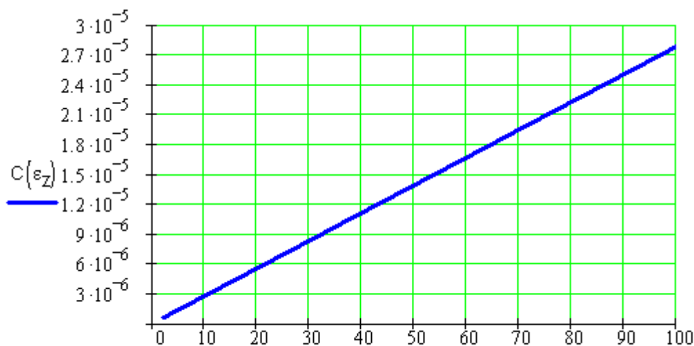
Рисунок 6 – Залежність ємності циліндричного конденсатора від діелектричної проникливості матеріалу
