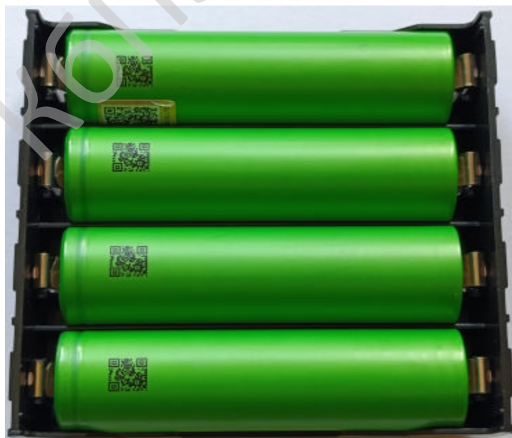
Рисунок 3.2 – Акумулятори 18650, 4 штуки, в холдері
