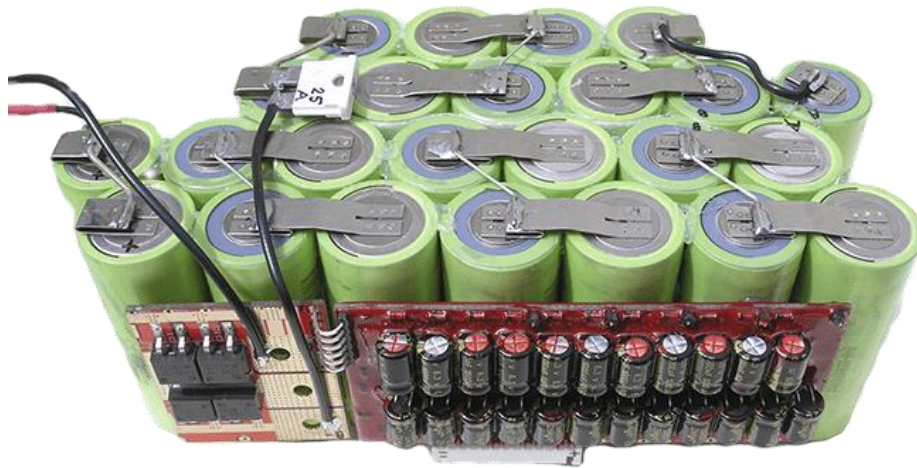
Рис. 7.5 Зовнішній вигляд літій-іонного акумулятора із елементів по 3,7 В та платою керування BMS
