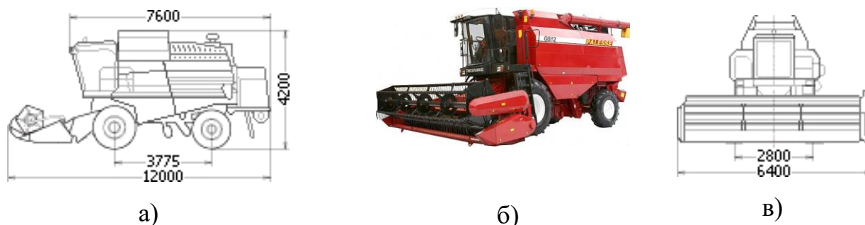
Рисунок 4.1 – Зовнішній вигляд (б) та габаритні розміри (а, в) самохідного комбайну КЗС-1218 «ПАЛЕССЕ GS12»
