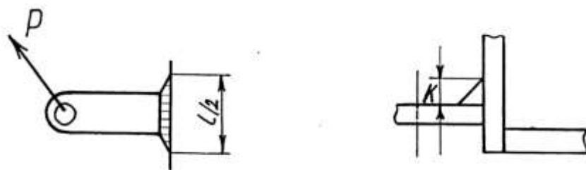
Рис. 6. Схема зварного з'єднання кріплення регулювальної заслінки подрібнювача соломи зернозбирального комбайна ДОН-1500Б
