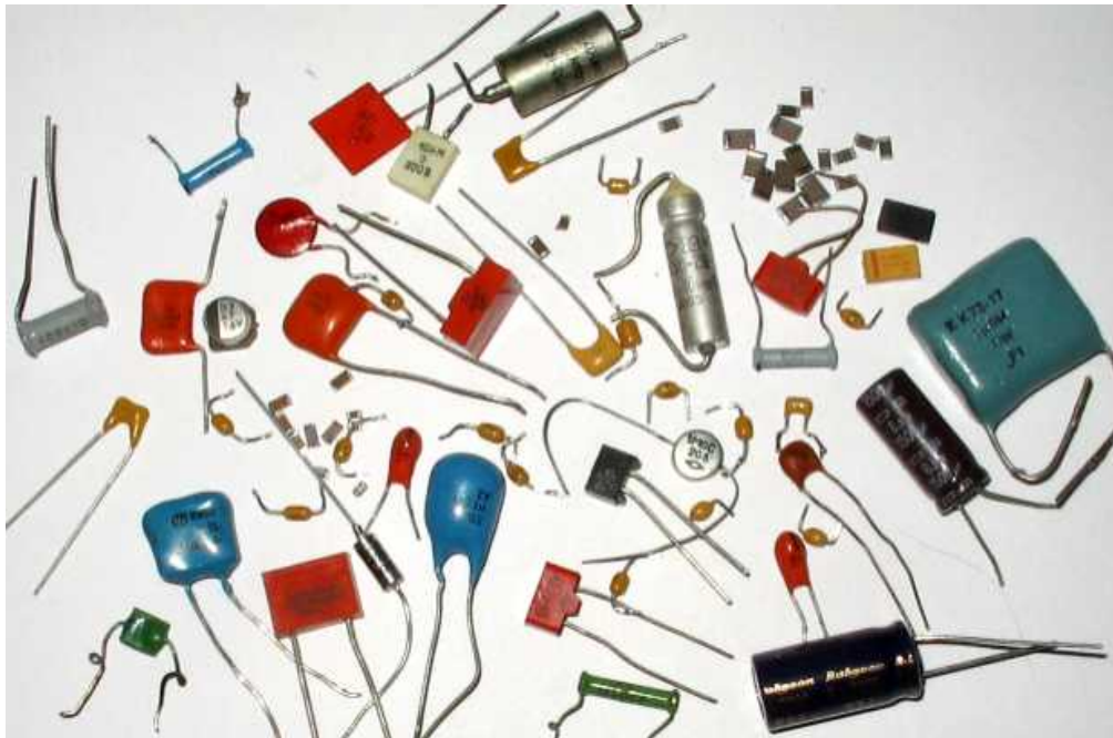
Рисунок 2.7. Зовнішній вигляд різних типів конденсаторів.
