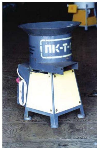
Рис. 3.1. Загальний вигляд подрібнювача ПК-Т-1
