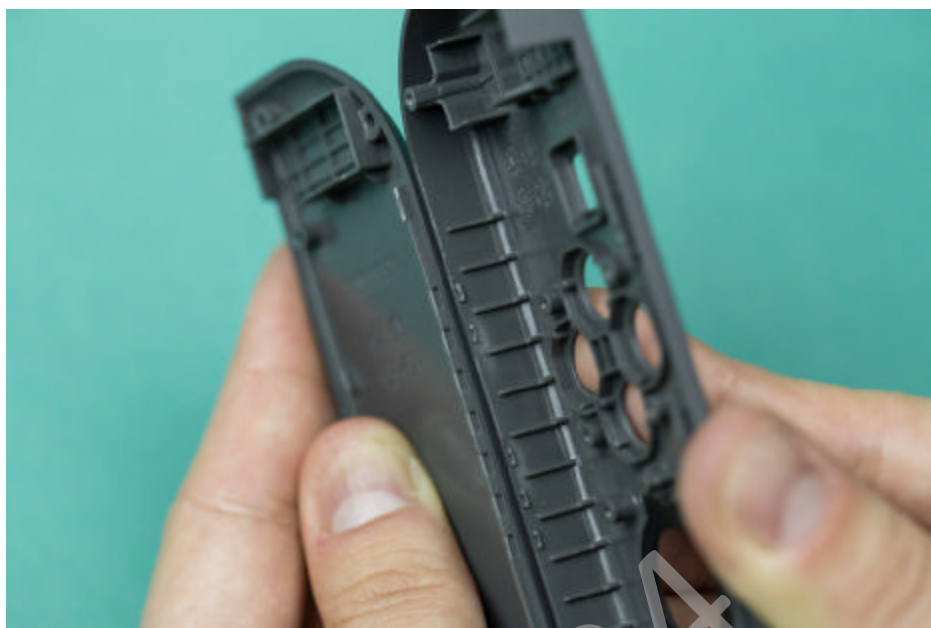
Рисунок 2.18 - Застібки на верхньому та нижньому корпусах Joy-Con
