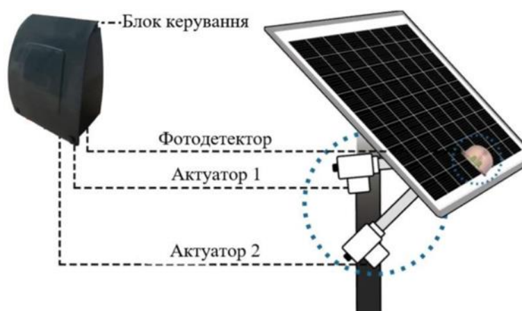
Рисунок 2.4 – Зображення трекера з фотодетектором.
