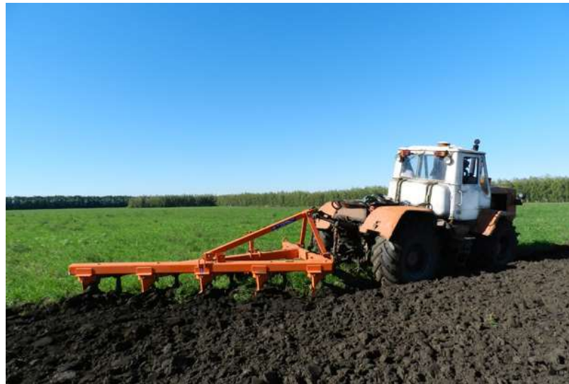
Рис. 1.1. Загальний вигляд знаряддя для полицевої оранки
