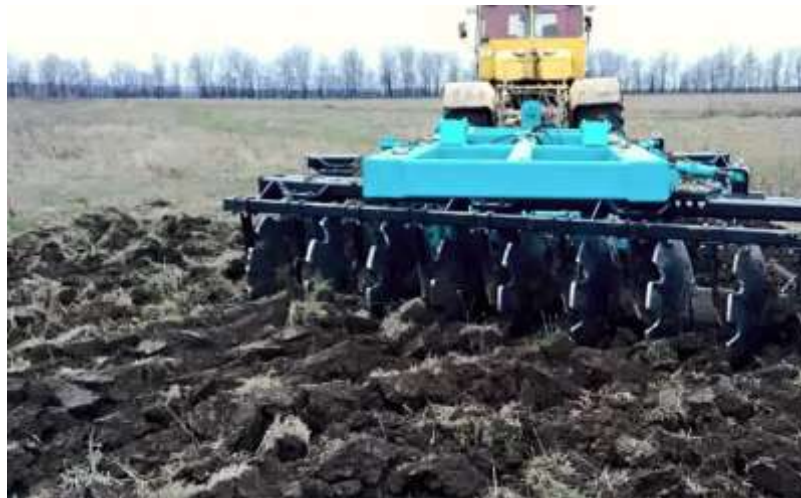
Рис. 1.3. Загальний вигляд важкої дискової борони для основного обробітку
