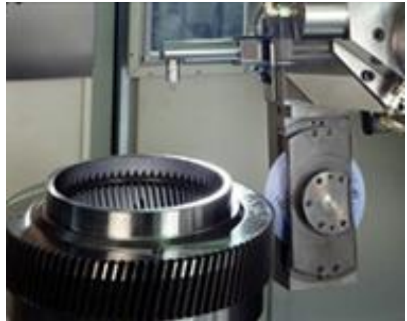
Рис. 4.6. Шліфування внутрішніх та зовнішніх зубців на верстаті мод. ZP10 ф. NILES
