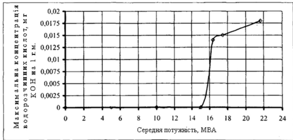
Рисунок 4.7 – Залежність максимальної концентрації водорозчинних кислот від середньої потужності.
