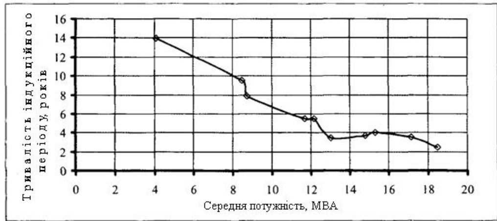
Рисунок 4.12 – Залежність тривалості індукційного періоду пробивної напруги масла від середньої потужності трансформаторів.
