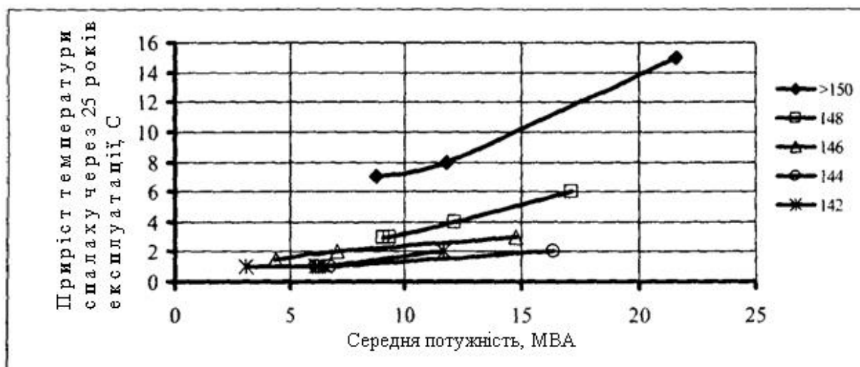
Рисунок 4.10 – Залежності значення приросту температури спалаху через 25 років експлуатації від середньої потужності для трансформаторів, що мають різне значення температури спалаху на момент заливки масла.
