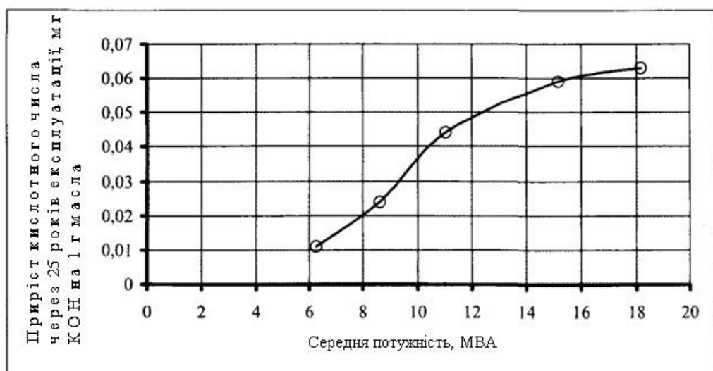
Рисунок 4.4 – Залежність приросту кислотного числа через 25 років експлуатації від значення середньої потужності трансформаторів.
