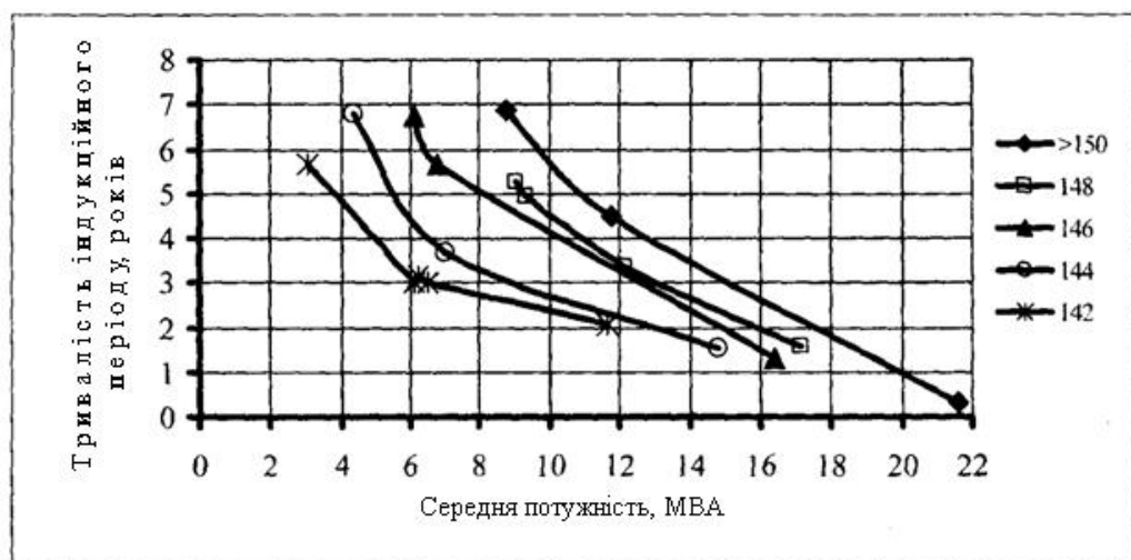
Рисунок 4.9 – Залежності тривалості індукційного періоду температури спалаху від середньої потужності для трансформаторів, що мають різне значення показника на момент заливки масла.
