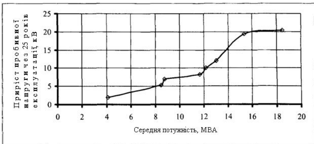
Рисунок 4.13 – Залежність приросту пробивної напруги трансформаторного масла через 15 років експлуатації від середньої потужності трансформаторів, які мають різне значення температури спалаху на момент заливки масла.
