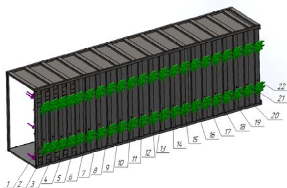
Рисунок 8 – Схема розміщення швелерів на CAD - моделі кузова Джерело: розроблено авторами
