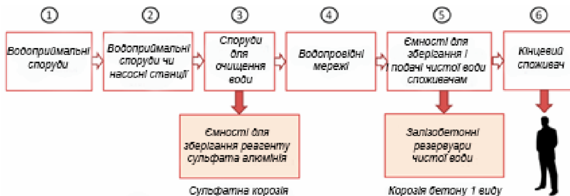
Рисунок 1.2 – Споруди що входять в склад системи водопостачання
