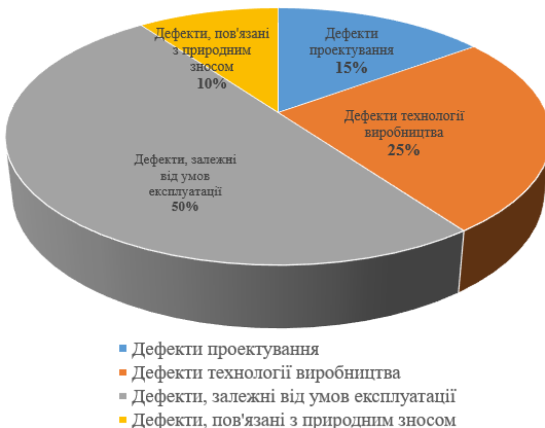
Рисунок 1.5 - Класифікація причин виходу з ладу заглибного електродвигуна
