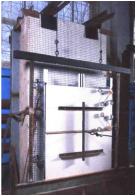
Рисунок 1.13 - Стенд для випробування фрагментів фасадних систем.
