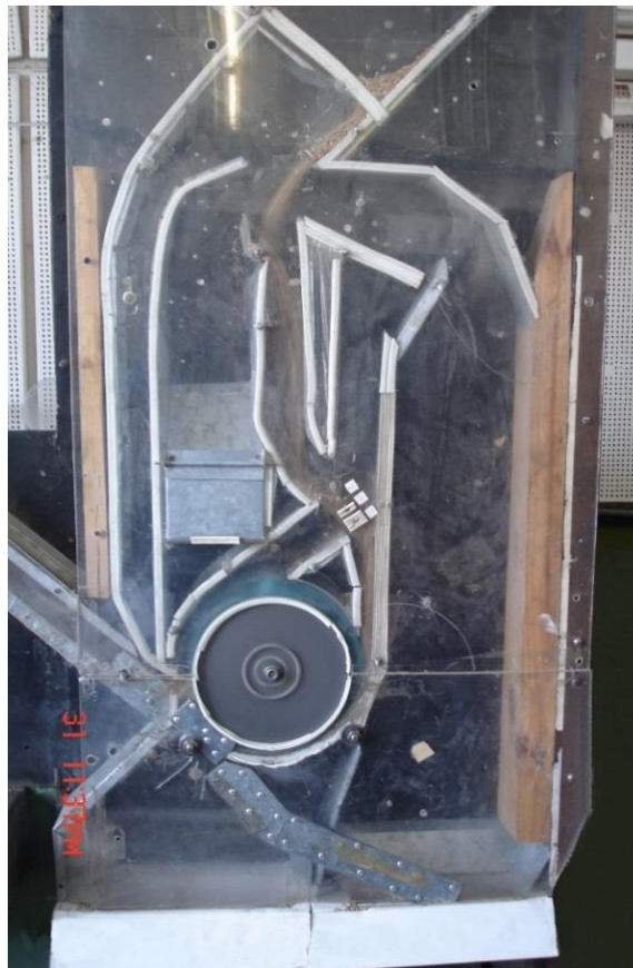
Рис. 2.9. Експериментальна установка для дослідження параметрів осадового пристрою пневмосистеми зерноочисної машини МЗП-10
